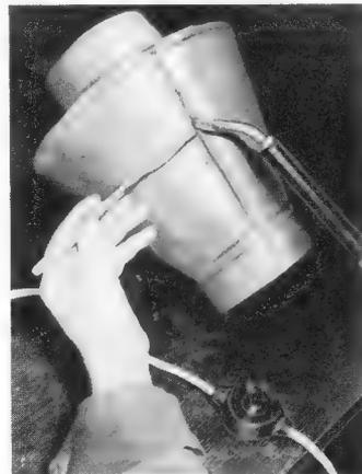
zum Signieren von Holz, Pappe, Leder oder Kunststoffen, oder mit einem Einsatz zum Schneiden und gleichzeitigen Säumen von Kunststoffen, Mipolam und PVC-Material versehen werden. Das Bild zeigt den Kolben mit schwerem Kupfer-einsatz beim Löten einer Zinkabdeckung, eine Arbeit wie sie z. B. auch bei Antennen-Anlagen vorkommen kann. Heizkörper und Lötensatz sind leicht auszuwechseln, so daß sich dadurch eine recht vielseitige Anwendbarkeit ergibt (Inco, F. W. Bäumer, Ahlen/Westf.).
